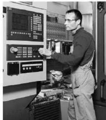
Bild 5: An diesem den Vorschriften entsprechenden Bearbeitungscenter darf nur im Normalbetrieb allein gearbeitet werden. Für die Behebung von Störungen, für den Werkzeugwechsel und für Instandhaltungsarbeiten muss eine Sicht- und Rufverbindung zu einer zweiten Person bestehen.
